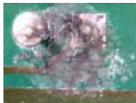
85 85%RH测试 中助焊剂残留物 造成的腐蚀问题
